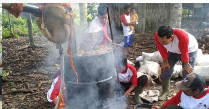
Pembuatan cuka kayu (Dokumentasi KTH Mencolok II Jambi)
